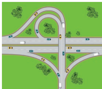
Exemple de carrefour dénivelé avec échanges.
